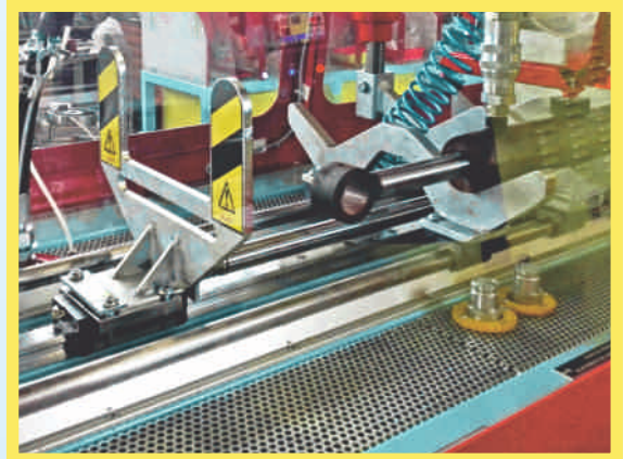
Carrello guida stelo esterno alla struttura. OPTTT0000024
